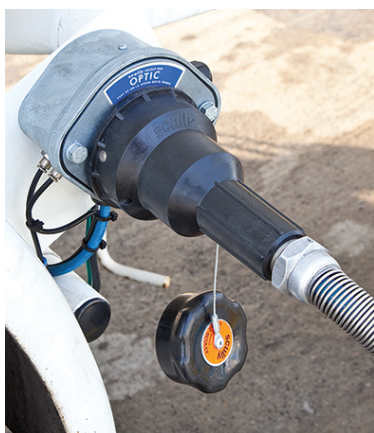
Uma única conexão para Prevenção de Transbordo e Aterramento Estático
