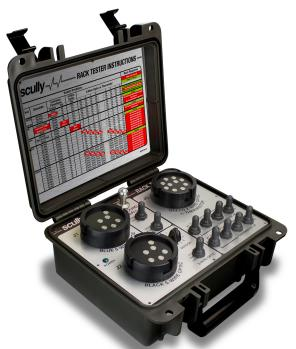
El Scully Probador de Pórtico es un probador portátil completo y avanzado aprobado para realizar pruebas en áreas clasificadas. Permite a los clientes y al personal de campo de Scully evaluar rápidamente cualquier controlador de pórtico de identificación de vehículos, puesta a tierra estática y prevención de sobrellenado de Scully para determinar el funcionamiento adecuado del equipo. En caso de mal funcionamiento, facilita la resolución de problemas.
